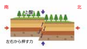
▲逆断層。上盤が次第に崩れる
