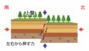
▲逆断層。上盤が次第に崩れる
