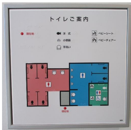
写真① 触知案内図を設置
