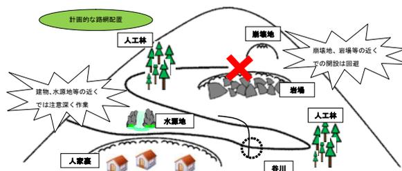
森林作業道の開設にあたっては、間伐をはじめとする森林整備、木材生産のために継続的な使用に耐えられるよう、地形に沿った線形で堅固な土構造を基本とし、作設費用を抑えつつ、丈夫で利用しやすい構造となるよう配慮する。
