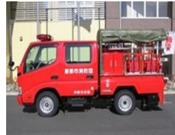
小型動力ポンプ付積載車（更新同等車両）
