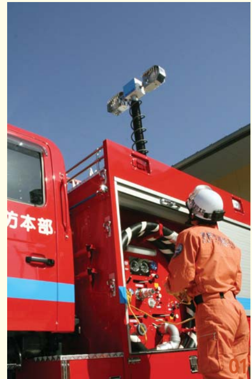
01 毎朝行われている車両点検。夜の出勤に必要なライトの動作チェック02器具の一つ一つを点検。写真の器具はシャッターなども切ることができるエンジンカッター。03 車両の点検を終え、異常無しの報告をする。
