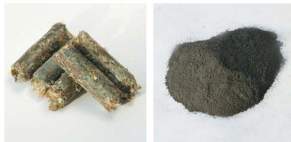
RDF(左上)とは、家庭などから出るごみを粉々に砕き、それを固めて作る燃料です。しかし、RDFの使用用途は、燃料のみと限られています。RDF炭化物(右上)とは、RDFを炭化したものです。RDF炭化物の使用用途は、主に製鉄用副資材やセメントの燃料などに活用されています。
