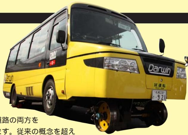
DMV (デュアル・モード・ビークル) とは、線路と道路の両方を走行できる乗り物で、JR北海道で開発が進められています。従来の概念を超えた新しい公共交通機関として期待されています。明知鉄道にDMVを導入した場合の利便性や、効率性を検証するため、DMVに乗り、アンケートにお答えいただくモニターを募集します。
