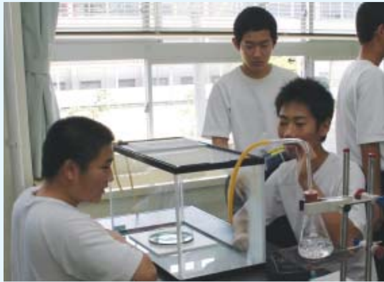
水槽の中で酸性雨を作る実験
