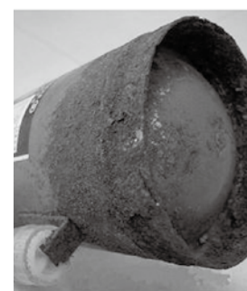
▲腐食が進んだ消火器
