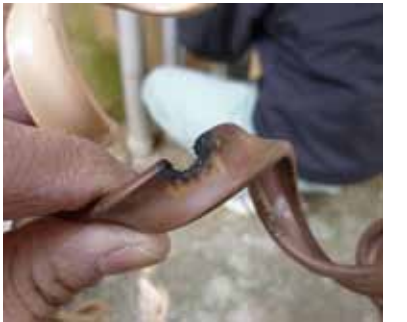
▲凍結防止ヒーターから出火
