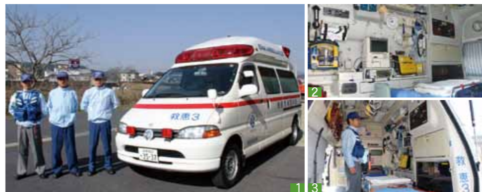
1 配備される高規格救急車 / 2 AEDなど救命に必要な装備を搭載 / 3 処置がしやすいように天井が高い車両内部
