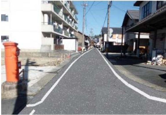
舗装イメージ(ロードアスファルト工法)
