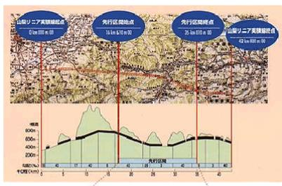
山梨リニア実験線では、超電導リニアモーターカーの車両開発はもちろん、複線・カーブ・勾配・トンネルなどの条件下における走行試験、さらに電力供給装置や列車のコントロール装置、安全管理システムなどの開発が、日本特有の起伏の富んだ地形、環境の中で確認されています。1997年(平成9年)から総延長42.8kmのうち優先的に建設された先行区間18.4kmで走行試験が行われ、2005年(平成17年)3月には、国の「超電導磁気浮上式鉄道実用技術評価委員会」から「実用化の基礎技術が確立した」との評価がなされたところです。
