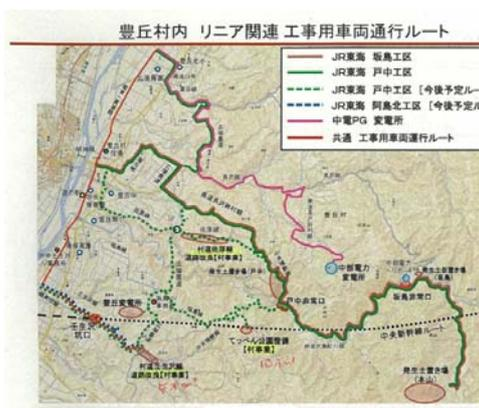
豊丘村では、トンネル掘削時の発生土置き場や変電所を山間部につくることにより、人が生活している地域を極力外した運行ルートが設定されている。また村内の生活道路は比較的幅員が狭いため、工事車両は2車線化された道路を極力通行することとし、JR東海関係の車両、中部電力の車両など分散して通行ルートを設定することで、地域の理解を得ている。
