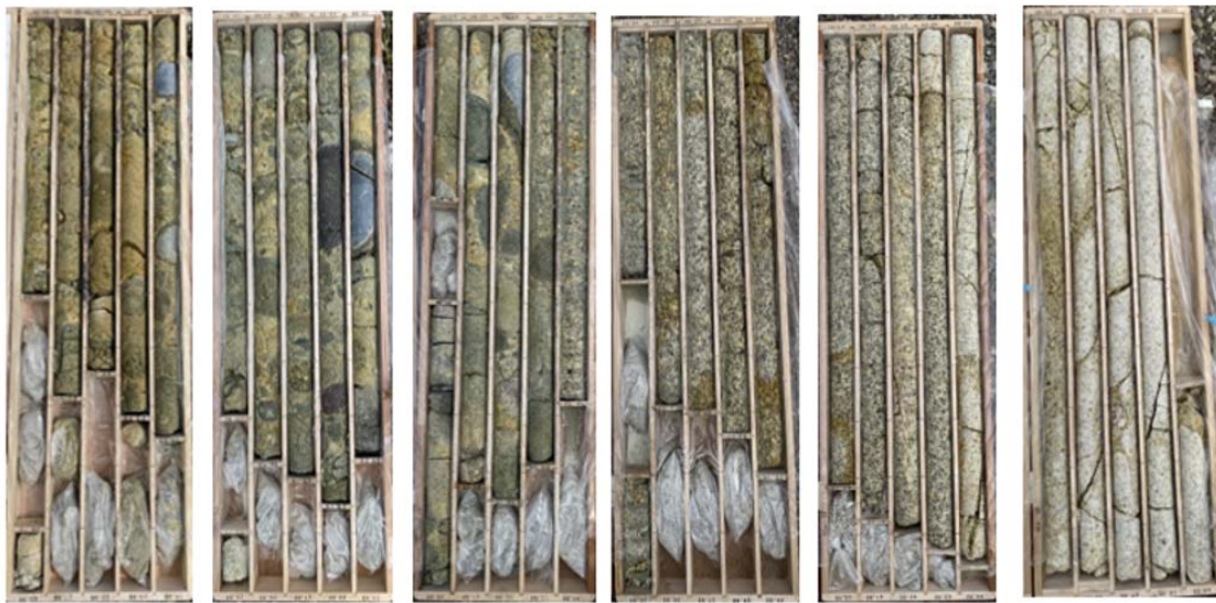
ボーリング結果から真砂土の深さを推定
